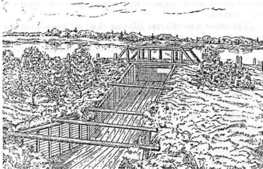
Рисунок 18 - Открытый водосброс из дерева (вид со стороны нижнего бьефа плотины)
